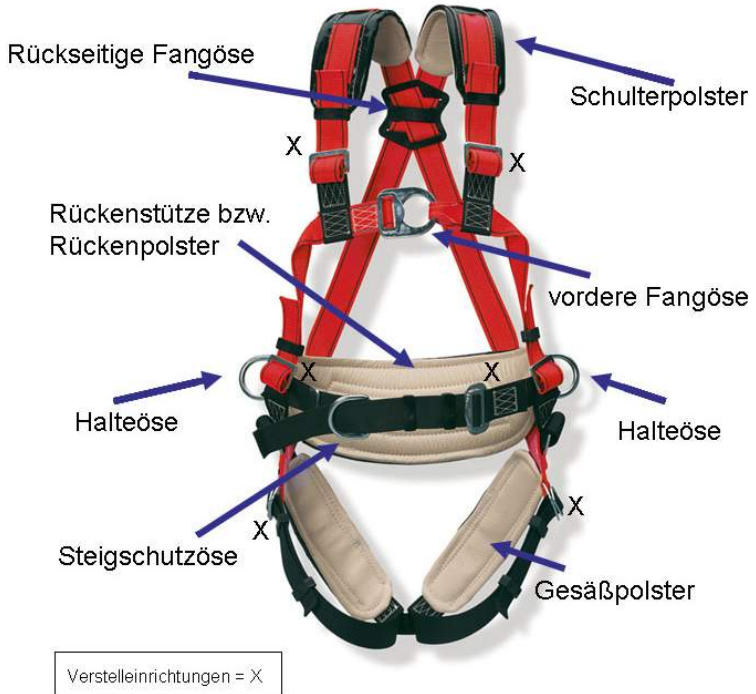
Bild 10: Beispiel eines Auffanggurtes mit vorderer und rückseitiger Auffangöse, seitlichen Halteösen und einer Steigschutzöse. Der Gurt ist zusätzlich mit Schulter-, Bein- und Rückenpolstern ausgestattet
