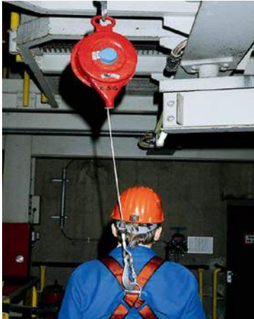
Bild 6: Beispiel eines Auffangsystems mit Höhensicherungsgerät
