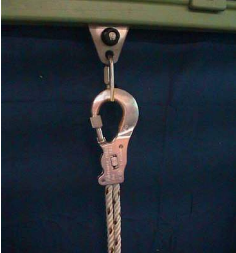
Bild 31: Anschlageinrichtung mit horizontaler Führungsschiene und beweglichem Anschlagpunkt
