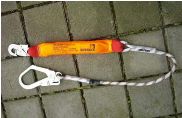
Bild 17: Verwendungsfertiger Aufreiß-Falldämpfer (Bandfalldämpfer) im Verbindungsmittel integriert
