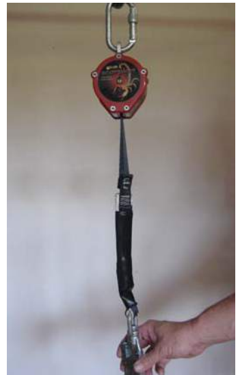
Bild 19: Höhensicherungsgerät mit Verbindungsmittel aus Gurtband
